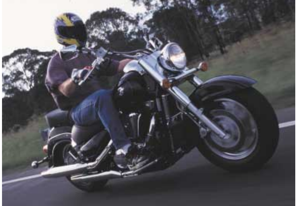
Aufgrund des langen Radstands und des flachen Lenkkopfwinkels rollt die LC sauber geradeaus.
