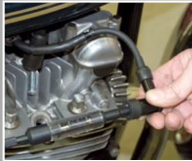
Zündspannung mit dem Zündspannungsprüfer testen
