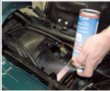
Starthilfe-Spray in den Luftfilterkasten sprühen
