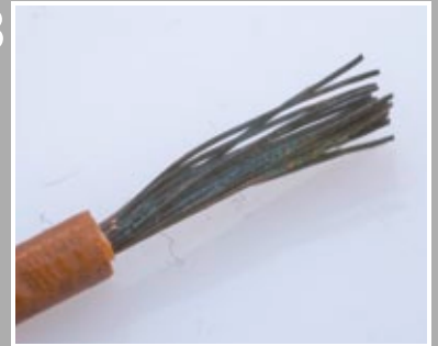
Grünspanige Kabelseele führt zum Spannungsabfall
