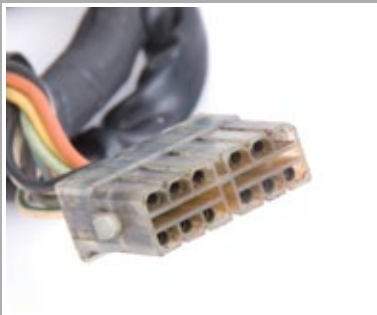
Korrodiertes Stecker – schlechter Kontakt
