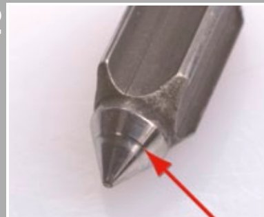
Verschlossenes Schwimmer-nadel-Ventil – auswechseln!
