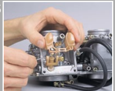
Achse herausziehen und Schwimmer entfernen
