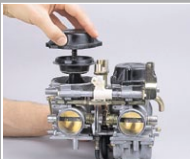
Vergaserdeckel und Schieber entnehmen
