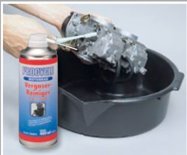
Vergaser äußerlich reinigen
