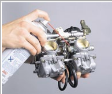
Alle drehbaren Teile neu einfetten
