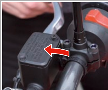
Vorgeschriebene Bremsflüssigkeit auf dem Deckel ablesen
