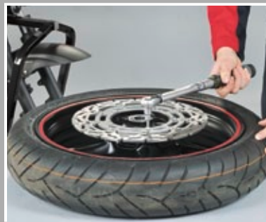
Neue Bremsscheibe aufsetzen und befestigen
