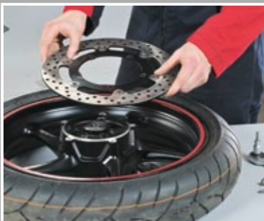
Alte Bremsscheibe abnehmen
