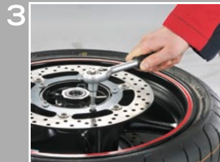
3 Befestigungsschrauben der Bremsscheibe lösen
