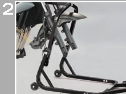
2 Radachse lösen und Rad entnehmen
