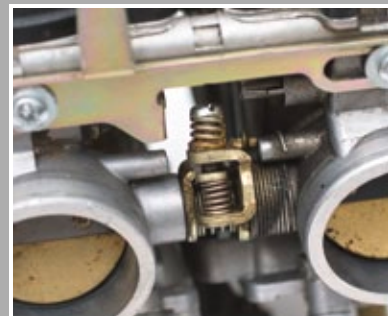
Einstellschrauben am Vergaser-gestänge
