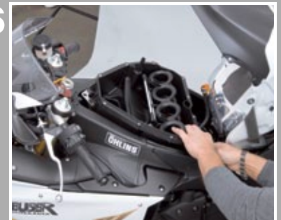
Das Luftfiltergehäuse muss ausgebaut werden
