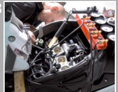
Anschluss der Unterdruckschläuche des Synchrontesters
