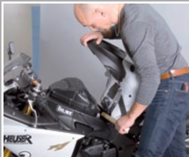
Tanks anheben und z.B. mit Holzstück fixieren
