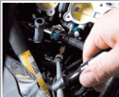
Bypass-Schrauben, gleiche Werte aller Uhren einstellen
