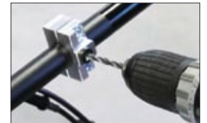
Einfaches Anbohren durch die Führungsbuchse
