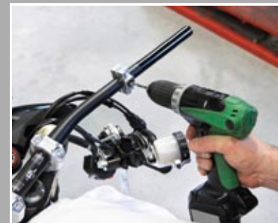
Anbohren des Lenkers mit der LSL Bohrschablone
