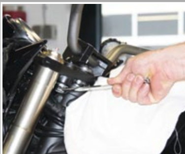
Demontage der originalen Lenkerklemmung
