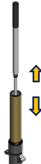
9. Prüfen Sie den Zustand der Teile. Kaputte Teile und/oder lecke Dichtungen sollten ersetzt werden. Wird eine Öldichtung ersetzt, müssen Sie auch den inneren Schlauch auf Schäden überprüfen. Säubern Sie alle Teile, bevor Sie sie wieder einbauen.
