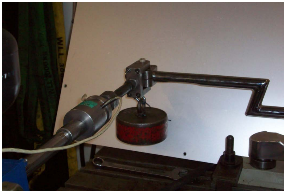
Prüfmuster auf Hydropulser / Test sample on hydro puls test bench
