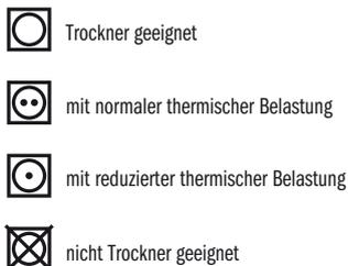
Die Punkte kennzeichnen die Trocknungsstufe des Wäschetrockners.
