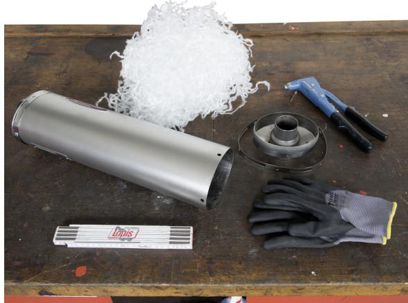
Znaleźć miejsce pozwalające na niezakłóconą, czystą pracę. Przygotować narzędzia i potrzebne części oraz stabilnie unieruchomić pojazd na stojaku. Upewnić się, że końcówka tłumika daje się zdemontować, np. poprzez rozwiercenie nitów mocujących. Przygotować do późniejszego montażu gazoszczelne nity jednostronnie zamykane oraz odpowiednią nitownicę.
