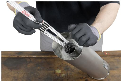
Plaats de eindkap zodanig op de geluiddemper dat de zeefbuis correct in het aanzetstuk kan worden geleid en de boorgaten voor de klinknagels weer op één lijn liggen. U kunt zich hiervoor aan de gemaakte markering oriënteren. Breng de boorgaten met elkaar in lijn, steek de gasdichte popnagels met de juiste diameter in de gaten en trek deze met de popnageltang stevig aan, zodat de draad van de nagel niet afscheurt.
