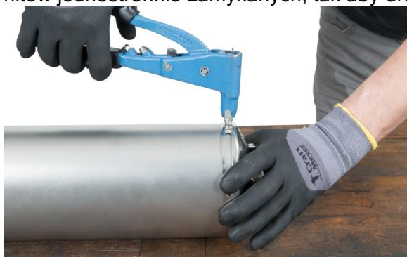
Gdy tłumik jest kompletny, zamontować go w sposób gazoszczelny na głównym kolanku/rurze układu wydechowego. Przed dokręceniem połączeń gwintowych ustawić tłumik beznaprężeniowo.
