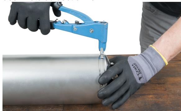
Une fois le silencieux réassemblé, montez-le si nécessaire avec un nouveau joint ou de la pâte d'étanchéité sur le collecteur principal/le tube de raccordement du dispositif d'échappement de sorte qu'il soit étanche aux gaz. Avant de serrer tous les raccords à vis, orientez le silencieux sur la moto sans appliquer de tension.
