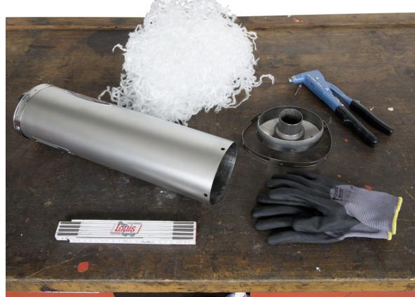
Suchen Sie sich einen geeigneten Platz für ungestörtes, sauberes Arbeiten. Legen Sie sich Ihr Werkzeug und die benötigten Umbauteile zurecht, bocken Sie das Motorrad sicher auf. Stellen Sie sicher, dass sich die Endkappe vom Schalldämpfer demontieren lässt, z.B. indem die Haltenieten weggebohrt werden. Besorgen Sie sich zur späteren Wiedermontage passende gasdichte Blindnieten und eine Blindnietzange aus unserem Sortiment.
