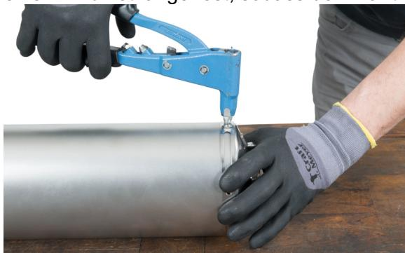
Ist der Schalldämpfer wieder vollständig, montieren Sie ihn ggf. mit einer neuen Dichtung oder Dichtpaste gasdicht am Hauptkrümmer / Verbindungsrohr der Auspuffanlage. Richten Sie ihn spannungsfrei aus, bevor Sie alle Schraubverbindungen zum Motorrad hin anziehen.
