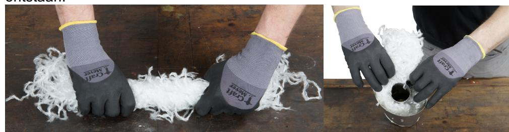
Schuif het nieuwe dempingsmateriaal met een geschikt gereedschap verder door, zonder het te sterk samen te persen. Plaats op deze manier het volledige afgewogen dempingsmateriaal gelijkmatig tot boven in de geluiddemper.
