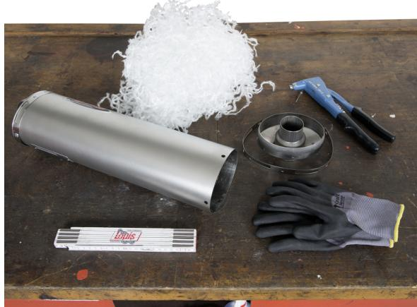
Zoek een geschikte plaats waar u ongestoord en schoon kunt werken. Leg het gereedschap en de vereiste ombouwonderdelen klaar, bok de motor veilig op. Controleer of de eindkap van de geluiddemper kan worden gedemonteerd door bijv. de klinknagels eraf te boren. Koop voor de latere terugplaatsing geschikte gasdichte popnagels en een popnageltang uit ons assortiment.
