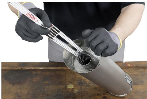
Coloque la tapa en el silenciador guiándose por la marca trazada de tal forma que el tubo perforado se introduzca correctamente en la prolongación y los orificios para los remaches vuelvan a estar alineados. Asegúrese de que los orificios queden perfectamente alineados, introduzca en los orificios remaches ciegos estancos al gas con el diámetro adecuado y apriételos con una remachadora para remaches ciegos hasta romper el alambre del remache.
