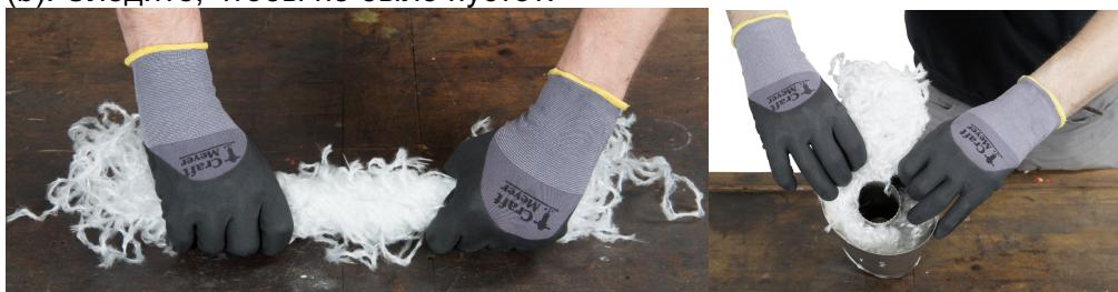
Задвиньте новый шумопоглощающий материал с помощью подходящего инструмента, не утрамбовывая его слишком сильно. Таким образом равномерно разместите весь взвешенный шумопоглощающий материал в глушитель до самого верха.
