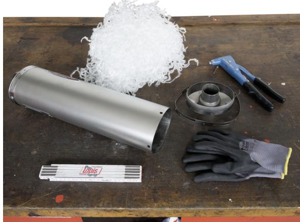
Individuare un luogo adatto per lavorare in condizioni di pulizia e senza essere disturbati. Preparare gli utensili e i componenti necessari, dopodiché posizionare la moto su un cavalletto in modo che sia ben salda. Accertarsi che la calotta terminale del silenziatore si possa smontare, per esempio rimuovendo i rivetti di fissaggio con un trapano. Procurarsi per il rimontaggio successivo rivetti ciechi a tenuta di gas adeguati e una rivettatrice del nostro assortimento.
