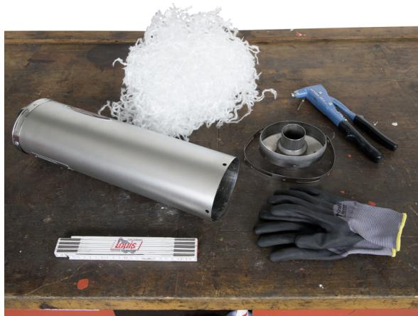
Cherchez un endroit approprié pour travailler proprement sans être dérangé. Préparez vos outils et les composants nécessaires et levez votre moto de manière sûre. Assurez-vous que l'embout du silencieux peut être démonté, par ex. en perçant les rivets de fixation. En vue du remontage ultérieur, procurez-vous des rivets aveugles appropriés et étanches aux gaz, ainsi qu'une pince à rivets aveugles de notre gamme.
