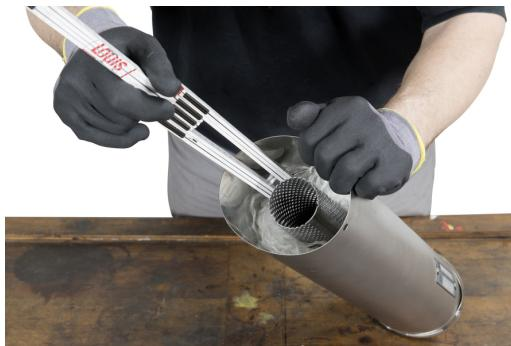
Końcówkę tłumika założyć w taki sposób, aby rura perforowana i otwory na nity ponownie się zbiegły, orientując się według naniesionego oznaczenia. Ustawić otwory dokładnie w jednej linii, wetknąć gazoszczelne nity o właściwej średnicy i osadzić je za pomocą nitownicy do nitów jednostronnie zamkanych, tak aby drut nitów uległ zerwaniu.
