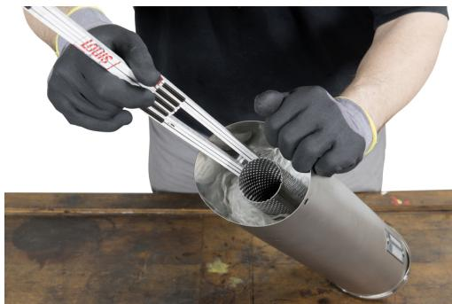
Наденьте на глушитель торцевую крышку таким образом, чтобы перфорированная труба правильно погрузилась в канал и чтобы отверстия под заклепки совпали, ориентируясь при этом на нанесенную ранее метку. Точно совместите отверстия, вставьте в отверстия герметичные глухие заклепки подходящего диаметра и зажмите заклепочными клещами до обрыва проволоки заклепки.
