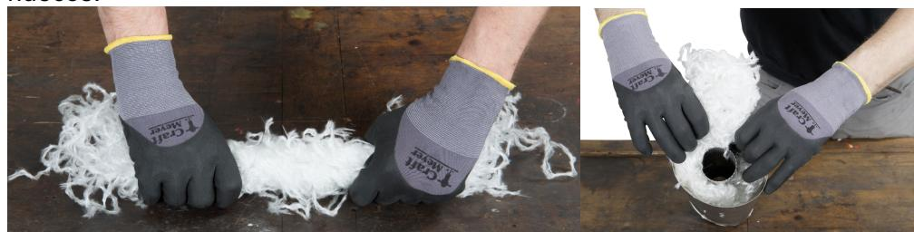
Continúe introduciendo fibra aislante nueva con una herramienta adecuada, sin llegar a comprimirla en exceso. Introduzca de este modo la cantidad fibra aislante pesada anteriormente distribuyéndola de manera uniforme hasta llenar el silenciador.
