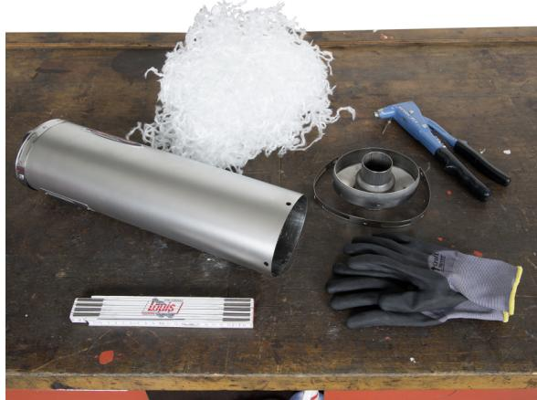
Выберите подходящее, свободное от помех и чистое для работы место. Удобно разложите инструмент и детали для переоборудования, надежно установите мотоцикл на подставку. Обеспечьте возможность демонтажа с глушителя торцевой крышки, например, высверлив для этого крепежные заклепки. Подберите для последующего монтажа подходящие герметичные глухие заклепки и заклепочные клещи из нашей программы принадлежностей.
