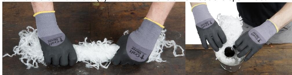
Spingere il nuovo materiale isolante con un utensile idoneo evitando di pressare eccessivamente. In questo modo, inserire l'intero materiale isolante pesato in modo uniforme fino alla parte superiore del silenziatore.
