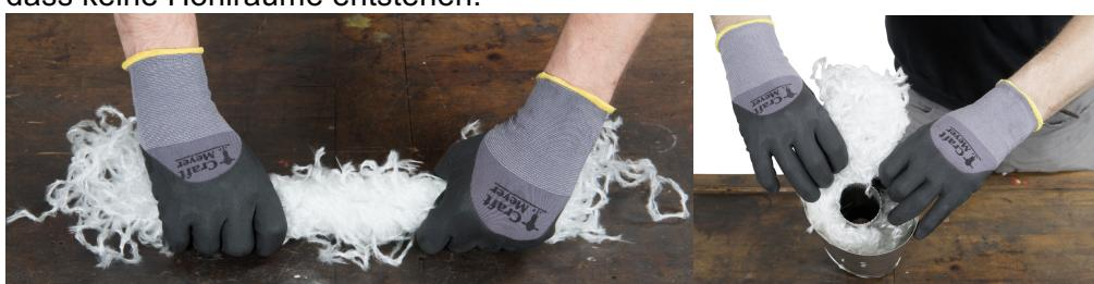
Schieben Sie neues Dämmmaterial mit einem geeigneten Werkzeug nach, ohne es zu stark zu pressen. Bringen Sie auf diese Weise das gesamte abgewogene Dämmmaterial gleichmäßig bis oben im Schalldämpfer unter.
