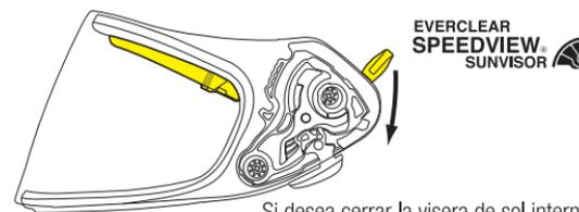
Si desea cerrar la visera de sol interna, presione hacia abajo la palanca doblar de la visera Speedview.
