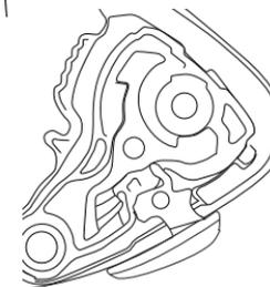
REMARQUE : Évitez de laisser le levier dans la position illustrée de 3 heures (position3), l'écran est alors ni verrouillé (position1) , ni déverrouillé (position 3).
