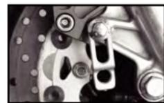
Installieren Sie die Sensorhalterung vom S-Typ.
