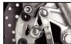
Stellen Sie die Position der Sensorhalterung so ein, dass der Sensor zum Magneten weist. Das verhindert, dass Sie nur ein schlechtes oder kein Signal erhalten.
