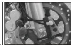
Installieren Sie den Geschwindigkeitssensor an der Halterung.
