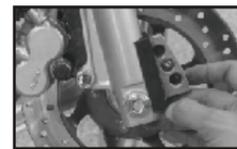
Installieren Sie die L-Halterung und den Anti-Rutsch-Gummi an der Vordergabel und stellen Sie die richtige Höhe und den richtigen Winkel ein.
