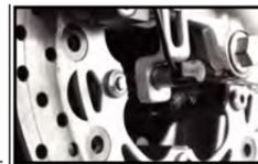
Installieren Sie den Geschwindigkeitssensor an der Halterung.
