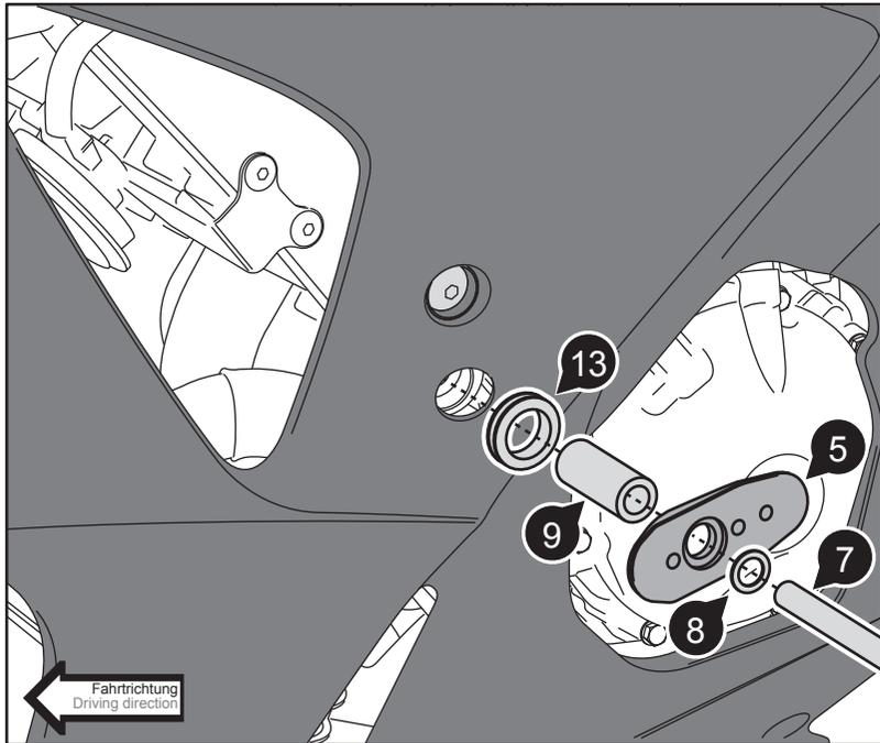
Setzen Sie die Gummitülle (13) in die gebohrte Öffnung ein. Montieren Sie die Teile (5), (7), (8) und (9), wie in der Zeichnung gezeigt. Richten Sie vor dem Anziehen der Schraube (7) die Basisplatte (5) entsprechend der Linienführung des Fahrzeugs aus. Ziehen Sie Schraube (7) an. Achten Sie dabei auf das vom Hersteller vorgeschriebene Anzugsmoment.
