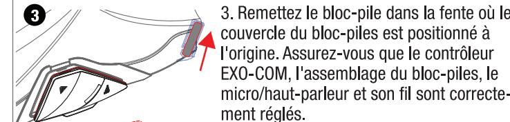
3. Remettez le bloc-pile dans la fente où le couvercle du bloc-piles est positionné à l'origine. Assurez-vous que le contrôleur EXO-COM, l'assemblage du bloc-piles, le micro/haut-parleur et son fil sont correctement réglés.
