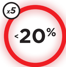
FIGURA 11: EJEMPLO DE SECUENCIAS DE DESTELLOS QUE INDICAN EL NIVEL DE CARGA DE LA BATERÍA
