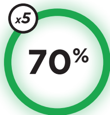
FIGURA 11: ESEMPIO DI SEQUENZA DI LAMPEGGIO INDICANTE IL LIVELLO DI CARICA DELLA BATTERIA
