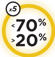
ABBILDUNG 11: BEISPIEL EINER BLINKSEQUENZ, DIE DEN LADEZUSTAND DER BATTERIE MELDET
