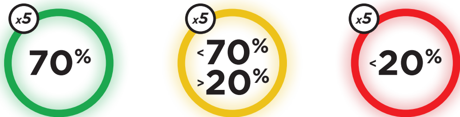
FIGURE 11 : EXEMPLE DE SÉQUENCE DE CLIGNOTEMENT INDIQUANT LE NIVEAU DE CHARGE DE LA BATTERIE
