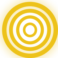
FIGURE 16 : SÉQUENCE QUI SIGNALE QUE L'ENREGISTREMENT N'A PAS EU LIEU, 5 CLIGNOTEMENTS PAR SECONDE
