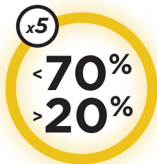
FIGURA 11: EJEMPLO DE SECUENCIAS DE DESTELLOS QUE INDICAN EL NIVEL DE CARGA DE LA BATERÍA
