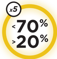
図11: バッテリー残量を表示するランプの点滅の例
