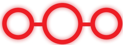
図14: エラーの表示。LEDが赤で点滅を続ける。
