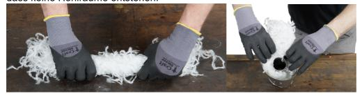
Schieben Sie neues Dämmmaterial mit einem geeigneten Werkzeug nach, ohne es zu stark zu pressen. Bringen Sie auf diese Weise das gesamte abgewogene Dämmmaterial gleichmäßig bis oben im Schälldämpfer unter.
