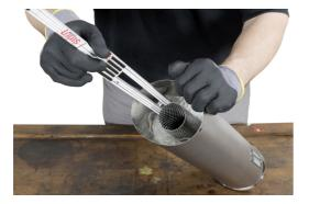
Setzen Sie die Endkappe so auf den Schalldämpfer, dass das Siebrohr korrekt in den Ansatz eintaucht und die Bohrungen für die Nieten wieder fluchten, orientieren Sie sich dabei an der
