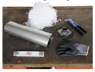
Suchen Sie sich einen geeigneten Platz für ungestörtes, sauberes Arbeiten. Legen Sie sich Ihr Werkzeug und die benötigten Umbauteile zurecht, bocken Sie das Motorrad sicher auf. Stellen Sie sicher, dass sich die Endkappe vom Schalldämpfer demontieren läßt, z.B. indem die Haltenieten weggebohrt werden. Besorgen Sie sich zur späteren Wiedermontage passende gasdichte Blindnieten und eine Blindnietzange aus unserem Sortiment.
