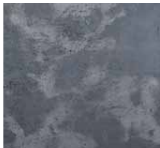
Links: Unbehandelte Stahlplatte zu Testbeginn. Mitte: Die VCI-konservierte Platte zeigt auch nach mehreren Wochen keinen Rostansatz. Rechts: Nach gleicher Dauer deutliche Spuren von Oxidation unter herkömmlicher Abdeckplane.
