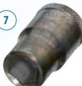
**7** Härten unter Schutzgasatmosphäre und anschließendes Anlassen.
