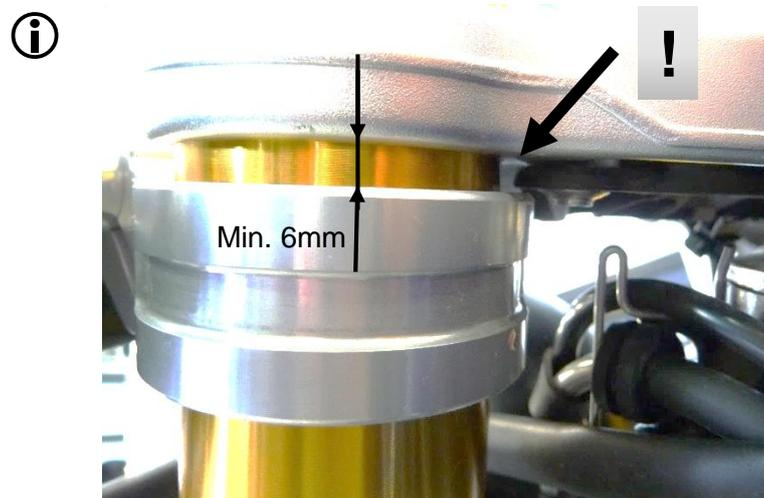
Speed Match Schellen mit M6x25mm bis ca. 6mm unter die Gabelbrücke schieben, so dass die Speed Match Schelle nicht mit dem Instrumentenhalter kollidiert!
