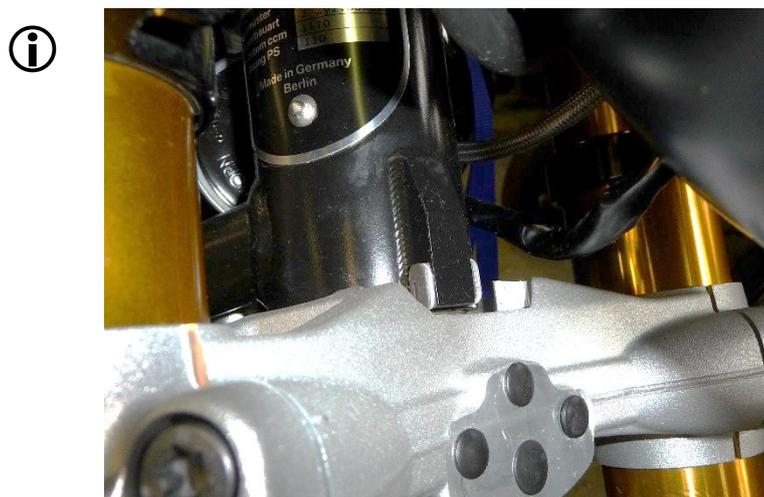
**Lenkanschlag begrenzen!** Um die erforderliche Freigängigkeit für den Lenker zu erreichen, muss der Lenkanschlag mittels beiliegender Distanzscheiben (2mm pro Seite) begrenzt werden. Diese Scheiben sind mit geeignetem Klebstoff aus dem Fachhandel auf den originalen Lenkanschlag zu kleben.
