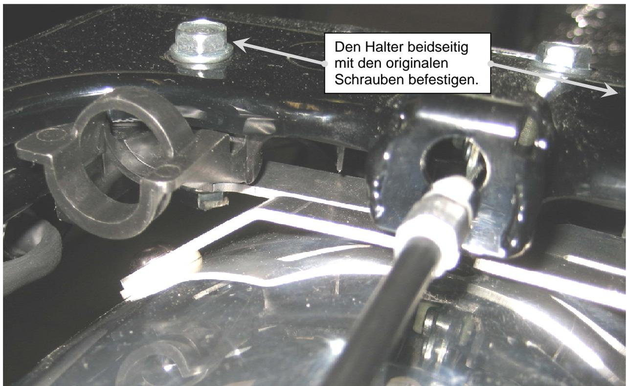
Zum Schluss den Kotflügel mittig ausrichten und alle Schrauben festziehen.
