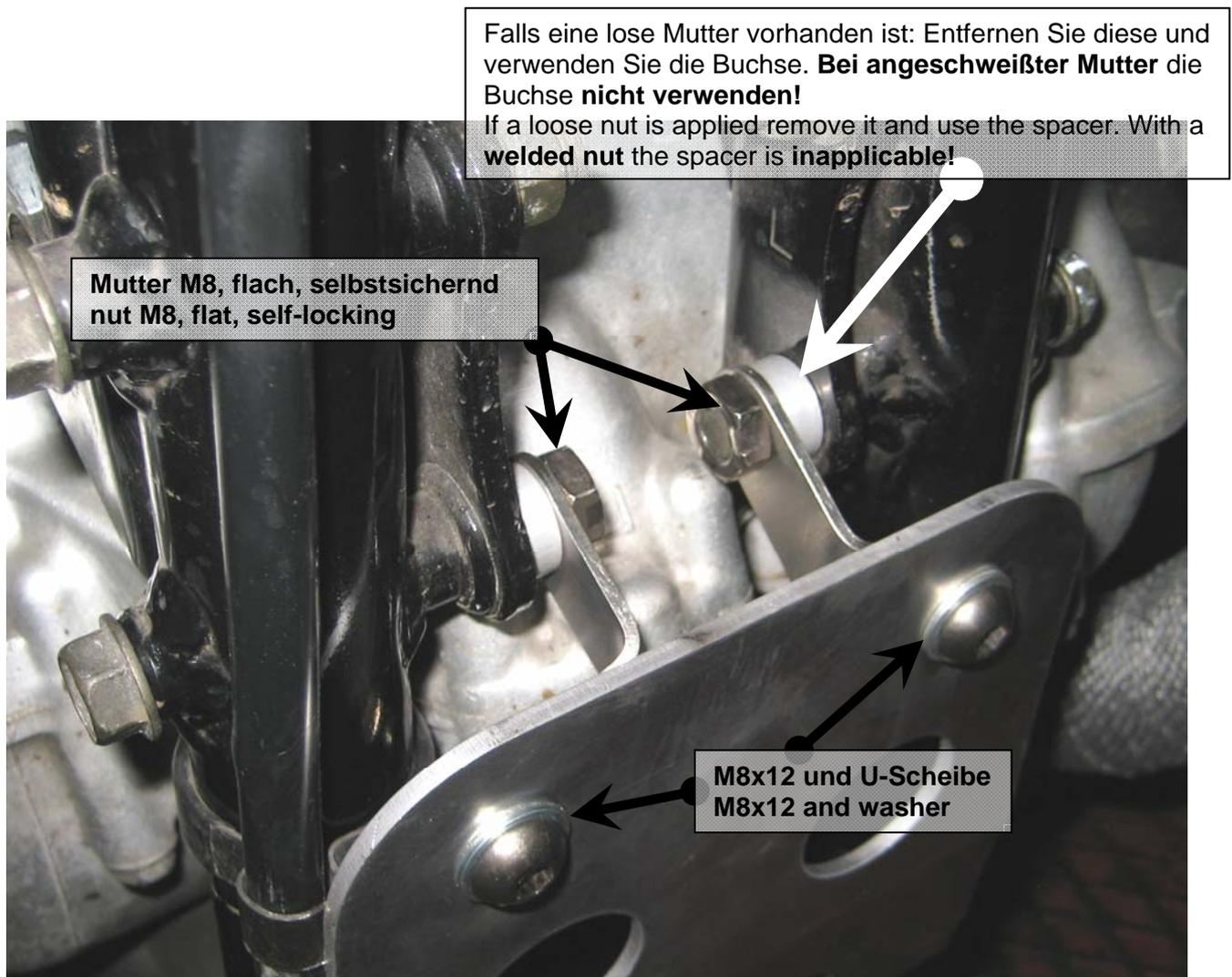
Stecken Sie die Schellen von außen über die Rahmenrohre, so dass die Bolzen auf der Innenseite nach unten zeigen. Befestigen Sie den Motorschutz an den Schellen und drücken ihn dann weitestmöglich nach hinten, während Sie alle Verbindungen endfest verschrauben.
