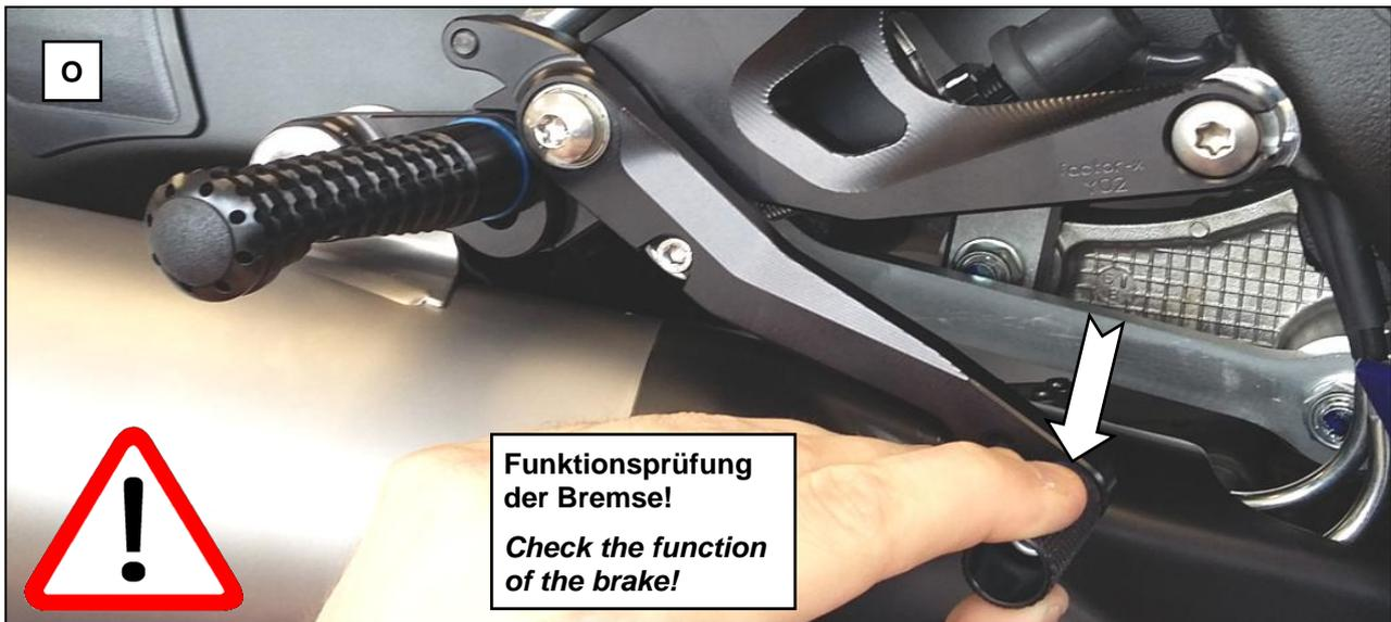
**-Zur Durchführung des folgenden Tests sollte das Hinterrad frei drehbar sein!**
