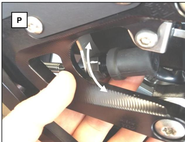
**P:** Stellen Sie die Sensibilität beim Auslösen des Bremslichtes ein. Drehen Sie dabei an der Kunststoff- Stellmutter des Schalters (am Sechskant). Mehrmalige Korrekturen sind möglich. (Testen Sie das Auslösen des Bremslichtes durch Betätigen des Bremshebels!)
