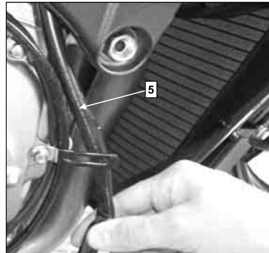
Kabelklemme (5) aufbiegen und das Kabel
