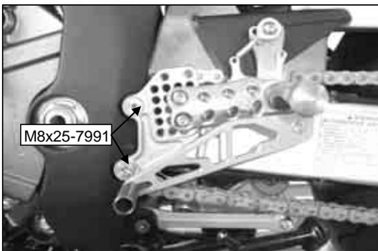
Fußrastenanlage mit Schrauben **M8x25-7991**
