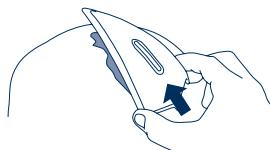
4. Pour terminer, insérez l'élément de commande dans le mécanisme, à travers la prise d'air.
