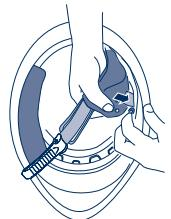
7. Setzen Sie den Akustikkragen wieder in die Führungsleiste zwischen Helmunterkante und Komfort-Wangenpolster ein. Beginnen Sie mit dem Einsetzen im hinteren Bereich und drücken Sie den Akustikkragen nach und nach langsam in die Führungsleiste.
