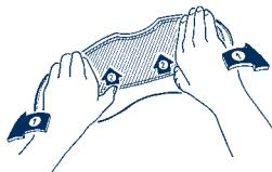
3. Agarrar la pantalla Pinlock® por detrás con el dedo índice y el corazón y levantarla de la pantalla exterior. En esa posición se pueda tirar de la pantalla Pinlock® ligeramente con el pulgar sacándola del perno de sujeción.
