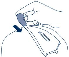
3. Tras la limpieza, vuelva a sujetar la cubierta de ventilación enganchándola en la zona delantera del mecanismo de ventilación y a continuación presionando en la calota hasta que oiga un claro "clic".
