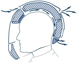
de la nuca, así como a través de los orificios de ventilación. De este modo, garantiza un clima especialmente agradable.
