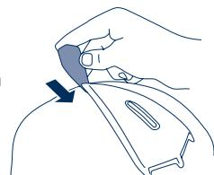
3. Bevestig de ventilatiekap na het reinigen weer door deze vooraan in te haken op het ventilatiemechanisme en vervolgens de helmschaal aan te drukken tot u een duidelijke klik hoort.
