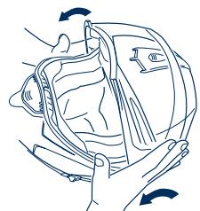
3. Compruebe que el mecanismo del visor funciona abriendo el visor hasta el tope.
