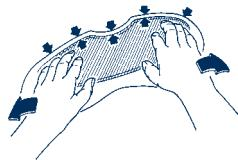
Daarvoor verwijdert u de Pinlock®-lens. De verbindingsbouten drukt u voorzichtig met behulp van een vlak, maar niet scherpgekant, voorwerp uit het buitenvizier. Draai tot 180° en breng opnieuw aan. Monteer daarna de Pinlock®-lens en controleer de pakking.
