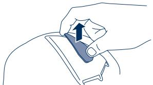
2. Schieben Sie anschließend das flache Ende des Bedienelements unter den Rand hinter der Belüftungshaube und lösen Sie die Belüftungshaube mit einer Hebelbewegung nach oben.
