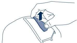
2. Ensuite, poussez l'extrémité plate de l'élément de commande sous le bord situé derrière la prise d'air et sortez la prise d'air en faisant levier vers le haut.
