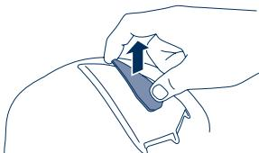
2. Empuje a continuación el extremo plano del elemento de mando debajo del borde detrás de la cubierta de ventilación y suéltela con un movimiento de palanca hacia arriba.
