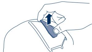
2. Schuif vervolgens het vlakke einde van het bedieningselement onder de rand achter de ventilatiekap en maak de ventilatiekap los met een hefboombeweging naar boven.
