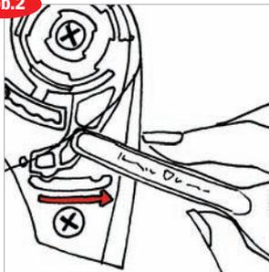
2. Ziehen Sie den L-förmigen Arretierhebel (Abb.2 und 3) an der Visiermechanik der rechten und linken Helmseite mit Hilfe des abgerundeten Stiels eines Suppenlöffels vorsichtig in die hintere Rastposition – das Visier springt nun aus seiner Aufnahme. Achten Sie darauf, dass Sie Ihre Helmlackierung nicht mit dem Löffel beschädigen.
