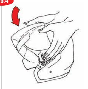
3. Setzen Sie das neue Visier nach oben weisend in die Aufnahme ein (Abb.4). Drücken Sie es an der jeweiligen Seite fest in die Aufnahme und schieben Sie den L-förmigen Arretierhebel (Abb.5) in die vordere Rastposition zurück. Achten Sie darauf, dass der Hebel in die dafür vorgesehene Aufnahme eingerastet ist (Abb.6).
