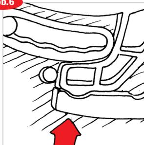
Der Visierwechsel ist abgeschlossen. Überprüfen Sie noch einmal, ob das Visier gut in den Nuten läuft und einwandfrei rastet, bevor Sie Ihren Helm wieder benutzen. Das Visier darf sich beim Bewegen nicht aus den Führungen lösen.
