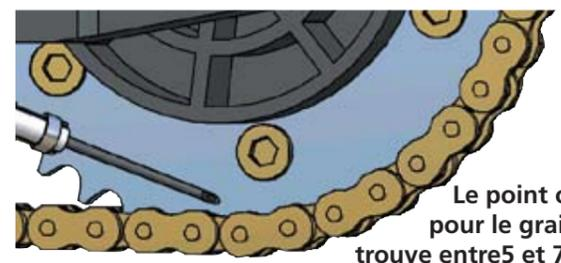
Le point optimum pour le graissage se trouve entre 5 et 7 H sur la face de la couronne arrière vue de la gauche de la moto.
