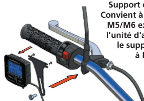
Support de montage. Convient à tout boulon M5/M6 existant. fixer l'unité d'affichage sur le support (pièce 5) à l'aide des vis M3 (pièce 16).
