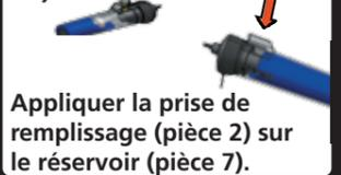
Appliquer la prise de remplissage (pièce 2) sur le réservoir (pièce 7).
