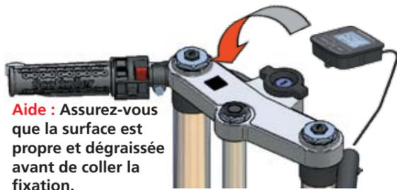
**Aide :** Assurez-vous que la surface est propre et dégraissée avant de coller la fixation.
