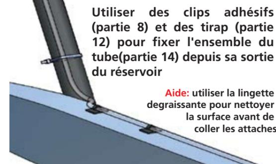
Utiliser des clips adhésifs (partie 8) et des tirap (partie 12) pour fixer l'ensemble du tube (partie 14) depuis sa sortie du réservoir
