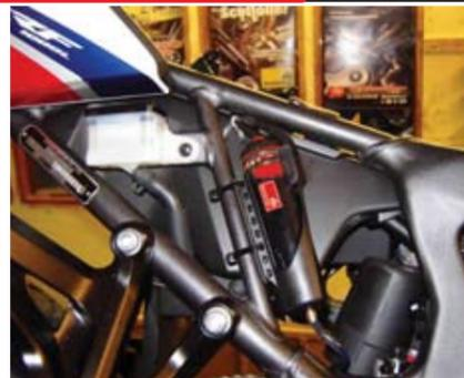
Un trou peut être fait sur la pince support pour qu'il soit attaché avec un boulon existant.
