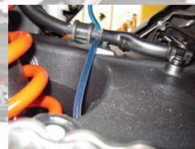
Fixez le tube de distribution à la conduite de freinage à l'aide d'un serre-câble.
