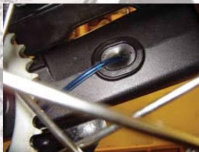
Enfilez à présent le tube de distribution dans le bouchon supérieur, remplacez les deux bouchons et ajustez doucement la tension du tube de distribution.
