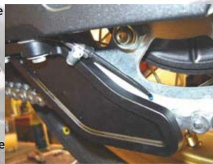
Placez la petite plaque de distribution contre le bras oscillant et refixez le protège-pied en plastique. Pliez la petite plaque de distribution de sorte que l'extrémité de l'embout de l'injecteur effleure le pignon arrière, la partie biseautée orientée vers l'extérieur.
