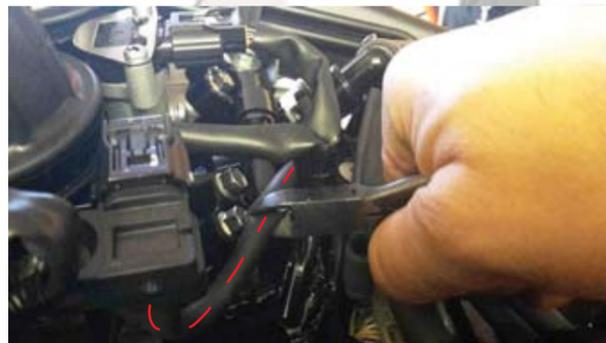
4. Retirez le support de verrouillage du siège.
