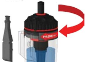
Connecter l'embout (part 17) à la prise de remplissage et presser la bouteille pour faire couler l'huile dans le tube jusqu'à ce que plus aucune bulle d'air ne soit visible
