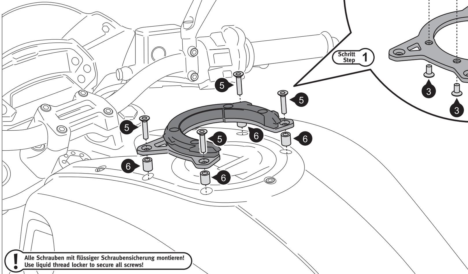
! Alle Schrauben mit flüssiger Schraubensicherung montieren!
