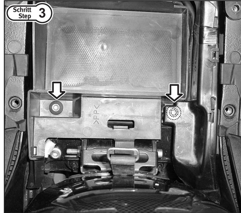
Entfernen Sie den Batteriekasten. Lösen Sie dazu die markierten Schrauben. Die rechte Schraube befindet sich unter der Kunststoffverkleidung des Kabelkanals.
