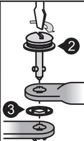
Benutzen Sie einen Schraubendreher um die QUICK-LOCK EVO-Kofferträger mit Hilfe der Schnellverschlüsse zu montieren / demontieren. Setzen Sie die Schnellverschlüsse an den mit dem Schnellverschluss-Symbol markierten Verbindungspunkten ein.
