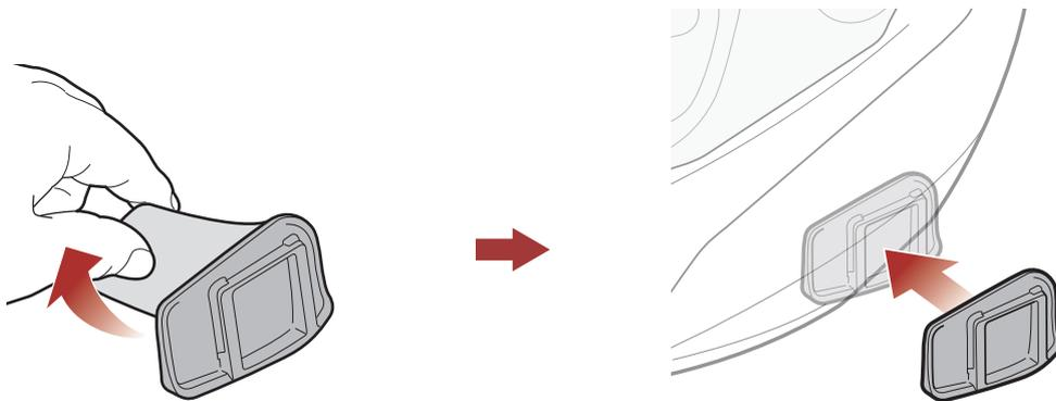
2. Vergewissern Sie sich, dass der selbstklebende Befestigungsadapter fest am Helm haftet. Die maximale Haftkraft ist nach 24 Stunden erreicht.
