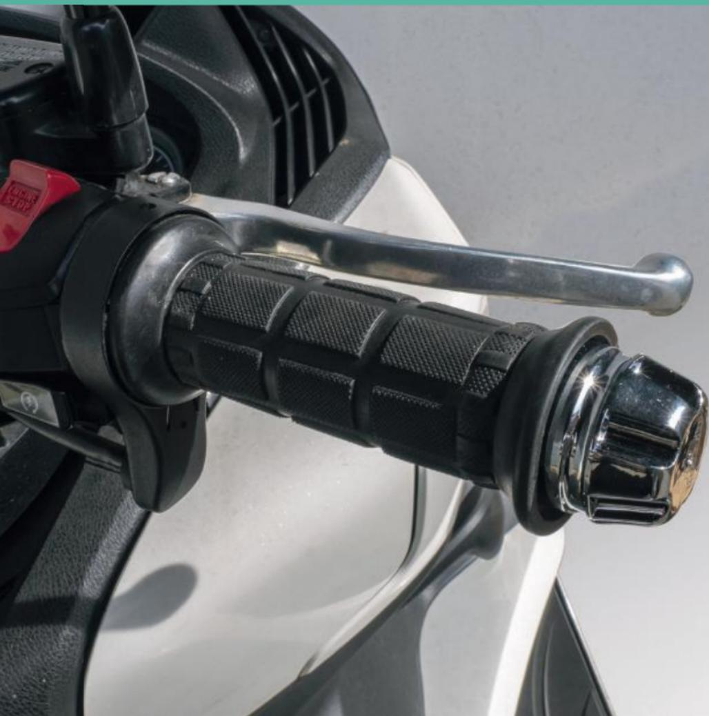
Rechte Griffereinheit mit Ring 8 auf den Kunststoffring 7 aufschieben. Gasgriffeinheit wieder zusammensetzen und Heizgriff mit Madenschraube fixieren.
