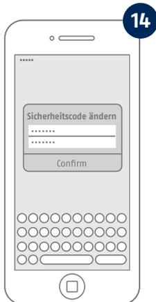
Bei der Erstinstallation muss der werkseitige Sicherheitscode 123456 geändert werden. Es wird empfohlen eine Kombination aus Zahlen sowie Klein- und Großbuchstaben zu verwenden.
