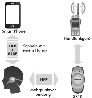
Parallele Verbindung des SR10 und des Handys per Bluetooth-Mehrpunktkopplung
