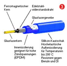
Wenn der Funke überspringen soll, muß die in der Zündspule erzeugte Hochspannung (bis zu 25 kV) erst einmal über Zündkabel zur Zündkerze "fließen" können. Damit das auch zuverlässig funktioniert, werden an diese Kabel eine ganze Reihe wichtiger Anforderungen gestellt.
