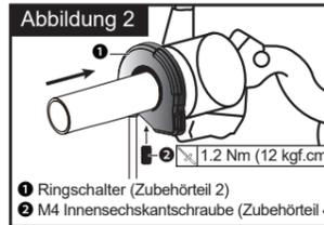
3. Bitte verwenden Sie ein entsprechendes Werkzeug, um den Ringschalter (Zubehörteil 2) am Griff zu befestigen.
