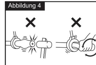
**VORSICHT!** Verwenden Sie keine Werkzeuge, um den Heizgriff auf den Lenker zu schlagen oder zu drehen, da sonst das Kabel im Griff beschädigt werden kann.
