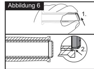
5. Um die Endkappen an den Heizgriffen zu montieren, setzen Sie zunächst den oberen Teil der Kappe in die obere Nut ein und drücken Sie die Kappe anschließend nach unten in die untere Nut.
