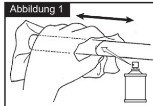
1. Entfernen Sie die Originalgriffe mithilfe eines geeigneten Werkzeugs.
