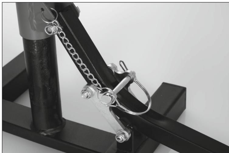
Esta protege la palanca contra un repliegue involuntario, que provocaría la bajada súbita/caída de la motocicleta. En torno a la chaveta partida se coloca el seguro de cable de forma que la chaveta no pueda salirse de su posición.
