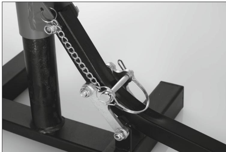
Dieser schützt den Hebel vor unbeabsichtigtem Zurückklappen, welches ein Herabfallen/ Kippen des Motorrades zur Folge hätte. Am Splint wird die Bügelsicherung umgelegt, sodass der Splint nicht aus seiner Position rutschen kann.
