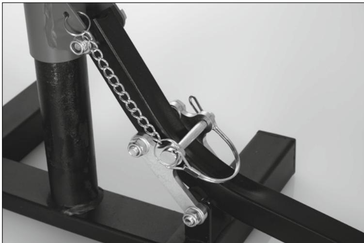
Он предотвратит неожиданное отскакивание рычага, в результате которого произойдет падение или опрокидывание мотоцикла. На шплинте имеется дуговой фиксатор, чтобы шплинт не мог высокочить со своего места.
