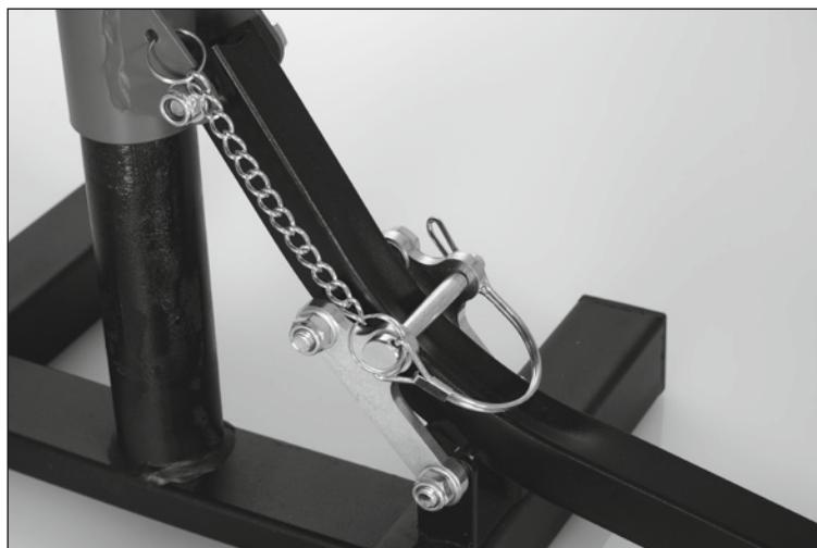
Zawleczka zabezpiecza dźwignię przed jej niezamierzonym zwolnieniem, co spowodowałoby przewrócenie/spadnięcie motocykla. Na zawleczkę zakłada się dostarczone w komplecie zabezpieczenie kabłkowe, aby uniemożliwić wysunięcie się zawleczki z otworu.
