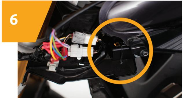
6 Fixez l'unité du STS à un point de montage stable. Le logo doit pointer vers le haut et la flèche dans la direction de la conduite.
