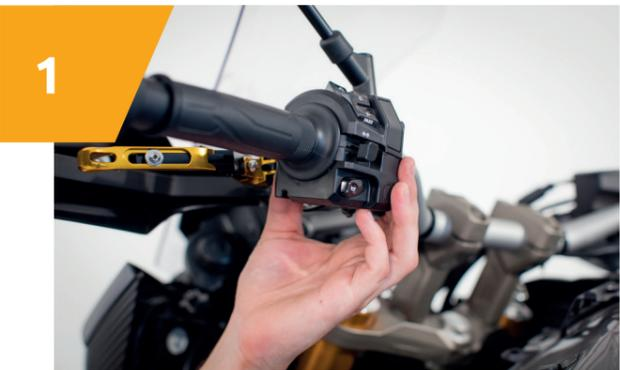
1 Localisez le câble à partir du commutateur sur le côté gauche du guidon et trouvez un endroit accessible.
