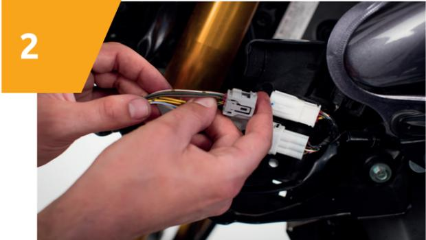
2 Retirez l'isolant principal, localisez et coupez 3 fils (de gauche, de droite et du relais de clignotant) et sertissez les connecteurs de la cosse rouge. Puis localisez l'alimentation électrique\* (12 V et GND).
