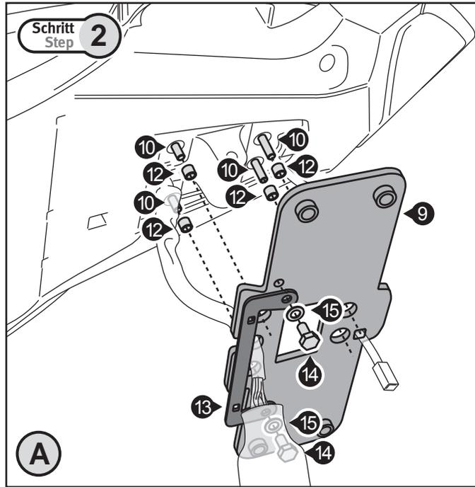
➔ Setzen Sie die Distanzbuchsen (12) auf die in Schritt 1 montierten Schrauben (10). Verschrauben Sie anschließend das Klemmblech (13) mit den Schrauben (14) und Unterlegscheiben (15) an der Quertraverse (9). Achten Sie darauf, den Kabelbaum der Radabdeckung zwischen dem Klemmblech (13) und Quertraverse (9) zu platzieren. Führen Sie das einzelne Kabel durch die quadratische Öffnung wie gezeigt.
