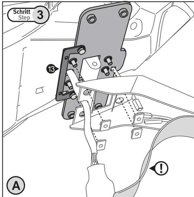
➔ Verschrauben Sie die Radabdeckung mit den originalen Einlegemuttern. Stellen Sie nach der Montage alle Steckverbindungen wieder her und schließen die Abdeckung der Radabdeckung mit den originalen Schrauben. Achten Sie darauf, dass die Abdeckung in die Vertiefungen des Klemmblechs (13) einrastet. Führen Sie final vor Fahrtbeginn einen Funktionstest aller elektrischen Komponenten der Radverkleidung durch.
