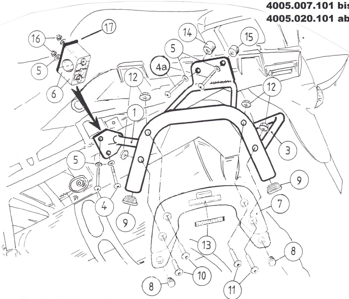
**Befestigungsschelle des Auspuffendrohres lösen und Endrohr soweit wie möglich nach innen ausrichten!!**
