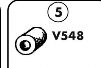
5 DISTANZIALE Ø16x26 foro 8,5 SPACER ENTRETOISE DISTANZSTUECK DISTANCIADOR
