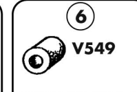
6 DISTANZIALE Ø16x22 foro 8,5 SPACER ENTRETOISE DISTANZSTUECK DISTANCIADOR
