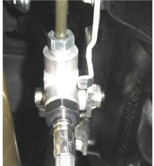
**Kupplungsschlauch (3):** Den Kupplungsschlauch, wie abgebildet, seitlich und hinter dem linken Standrohr zum Rahmen führen.
