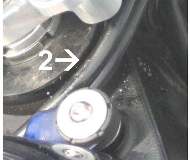
**Durit de frein (2):** Montez la durit de frein du kit avec les nouveaux anneaux de joint. Tenez compte des instructions de montage des durits de frein tressées en acier inox, ci-joint. Montez la durit de frein (79cm) avec le raccord coudé à 90° au maître cylindre de frein avant, comme indiqué ci contre, et attachez-la au bras de fourche avec un serre-fils. Faites passer la durit de frein à travers la fixation du té de fourche, comme à l'origine.
