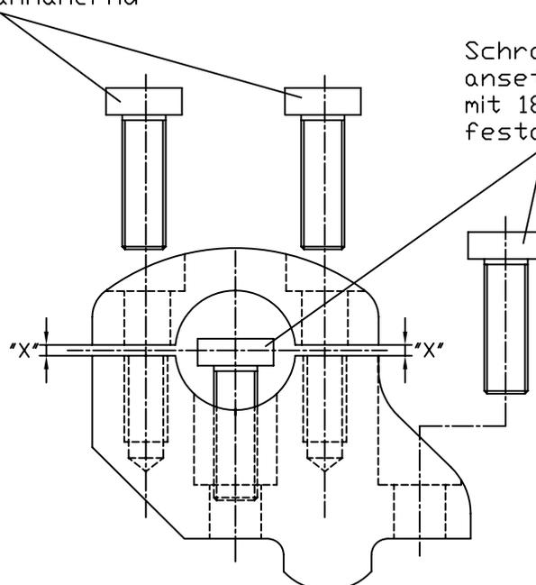
Schrauben M8x20/25 von Hand ansetzen und anschließend mit 18-20Nm Anzugsdrehmoment festdrehen!
