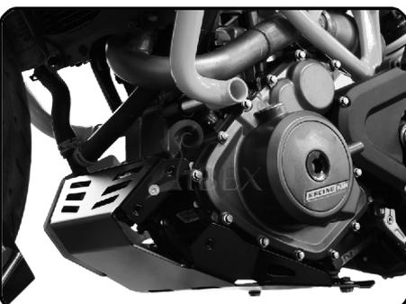
Linkes Seitenblech montieren
