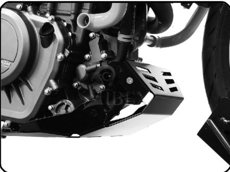
Rechtes Seitenblech montieren
