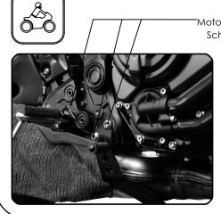
Motorschutzhalter Pos. 2.1 mit originalen Schrauben montieren, und Fußraste remontieren
