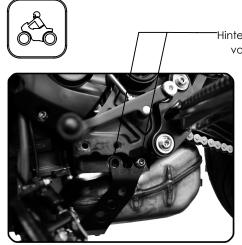
Hinteren Motorschutzhalter Pos. 2.1 mit Hilfe von den original Schrauben montieren
