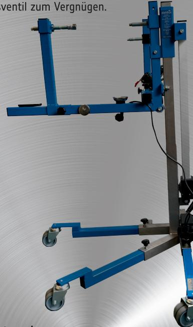
**Heben Sie das Motorrad nur vorne** bei Arbeiten z. B. an der Bremsanlage, beim Radwechsel, an der Gabel oder am Lenkkopflager.
